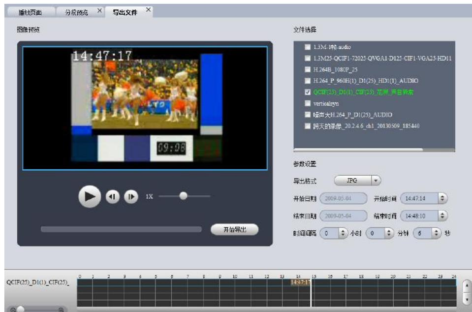
导出文件的功能：选中要导出的录像，通过预览设置导出的时间段，导出录像。导出的格式有 JPG、BMP、DAV、AVI。
