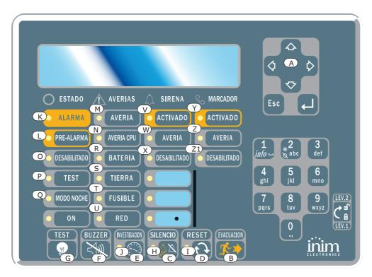
Figura 2 - Vista frontal del repetidor
